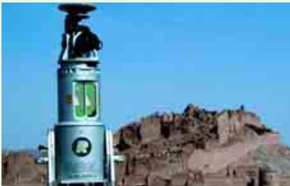
شکل ۴. استفاده از GPS به منظور زمین مرجع نمودن ابر نقاط
